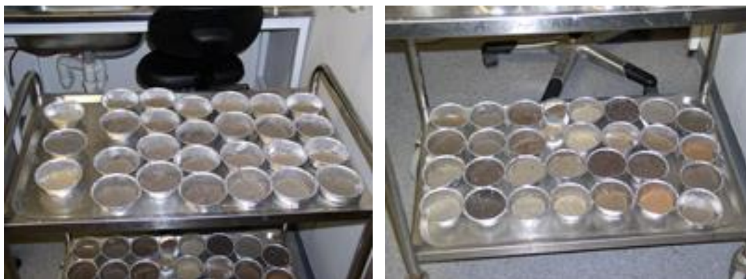
Figur 14. Lufttørking av prøver til XRF-analyse.
